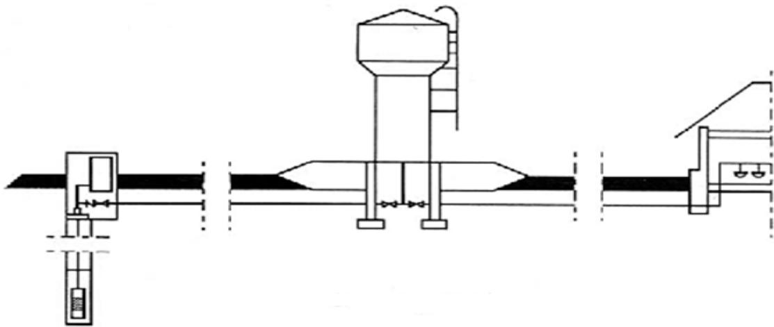
Наиболее широко применяемая система водоснабжения села – башенная. Надежная работа системы в автоматическом режиме, прежде всего, зависит от того, в какой степени учтены особенности, условия и режимы взаимного функционирования всех элементов системы: скважина, погружной насос, водонапорная башня, трубопровод, санитарно-технические приборы потребителя. Последнее определяет режим водопотребления, который диктует всю работу системы.
