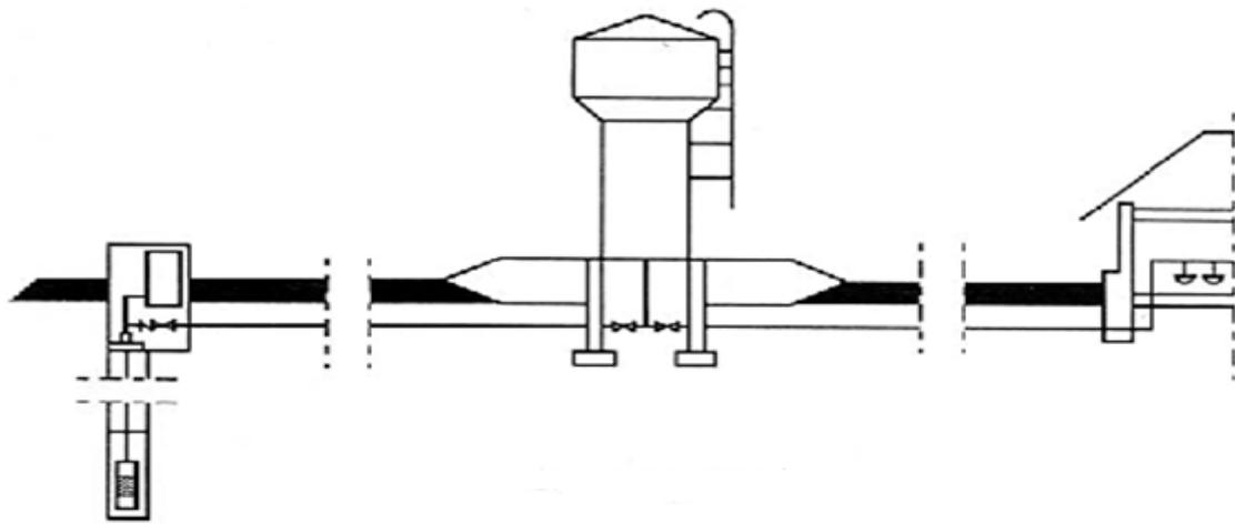
Надежная работа системы в автоматическом режиме, прежде всего, зависит от того, в какой степени учтены особенности, условия и режимы взаимного функционирования всех элементов системы: скважина, погружной насос, водонапорная башня, трубопровод, санитарно-технические приборы потребителя. Последнее определяет режим водопотребления, который диктует всю работу системы.
