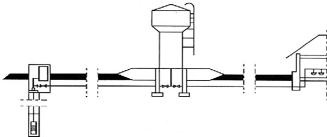
Надежная работа системы, прежде всего, зависит от того, в какой степени учтены особенности, условия и режимы взаимного функционирования всех элементов системы: скважина, погружной насос, водонапорная башня, трубопровод, санитарно-технические приборы потребителя. Последнее определяет режим водопотребления, который диктует всю работу системы.
